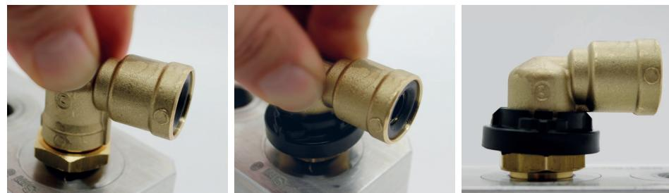
4. Сборка поворотного фитинга завершена и можно подсоединять трубку. Корпус может быть повернут в необходимом положении (поворот на 360°). Если вы установили анти-прогоротное кольцо и не опустили его вниз, то корпус фитинга может вращаться.
