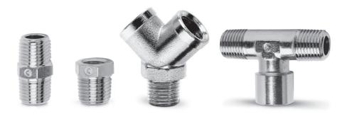
Серия 2000 включает прямые, Y-образные, T-образные и крестообразные фитинги с наружной или внутренней присоединительной резьбой до G1. Резьба трубная коническая по стандарту ISO 7 (BSPT); трубная цилиндрическая по стандарту ISO 228 (BSP).
